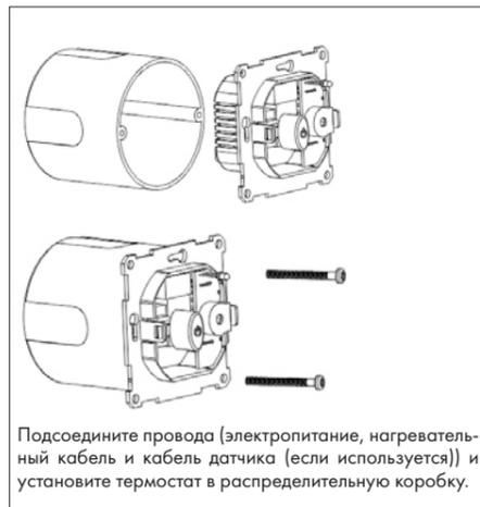
Подсоедините провода (электропитание, нагревательный кабель и кабель датчика (если используется)) и установите термостат в распределительную коробку.
