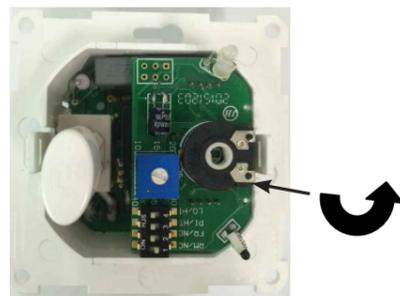
**Совет.** Перед установкой ручки настройки температуры верните потенциометр по часовой стрелке до упора. В этом случае ручка зафиксирована в положении 9.
