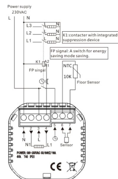
**ПРИМЕЧАНИЕ.** Максимальный ток нагрузки реле термостата составляет 16 А. Однако, чтобы обеспечить максимальный срок службы термостата, рекомендуется максимальный ток 14 А. При большей нагрузке сокращается срок службы электрических компонентов.
