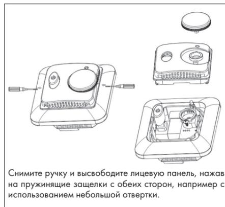
Снимите ручку и высвободите лицевую панель, нажав на пружинящие защелки с обеих сторон, например с использованием небольшой отвертки.
