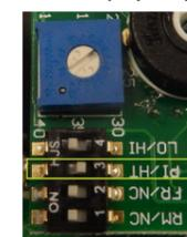
DIP-переключатель 3 в правом положении. DIP-переключатель 4 в положении, соответствующем нагрузке термостата (см. п. 1). Положение остальных DIP-переключателей не имеет значения.
