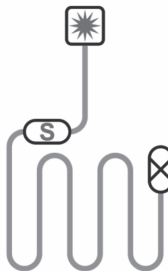
Схема укладки двожильного кабелю TXLP/2R
