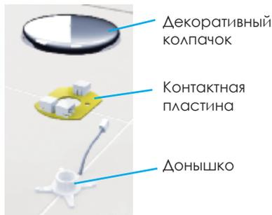
Датчики реагируют только в случае затекания воды под контактную пластину. Чтобы система среагировала на попадание воды необходимо, чтобы в контакте с колпачком образовалась лужица воды. На брызги, попадающие на декоративный колпачок, без образования лужицы, система не реагирует.
